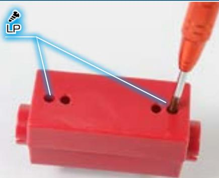
2 - Соедините детали (77А) и (77В) — они соединяются только в определенном положении. Скрепите обе эти детали двумя винтами LP. Не закручивайте винты слишком туго, поскольку в будущем их потребуется открутить для доступа внутрь.
